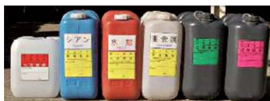
現在廃液貯留・搬入用に使用している廃液貯留容器とステッカー
