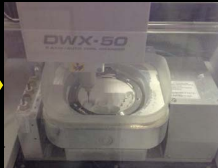
ジルコニアディスクの削り出し 歯科用ミリングマシンDWX-50® (Roland社)
