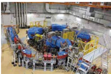
光速の約70%まで陽子を加速させる装置（シンクロトロン）で、がんを破壊する力を持った陽子線ができる。津山中央病院内。
