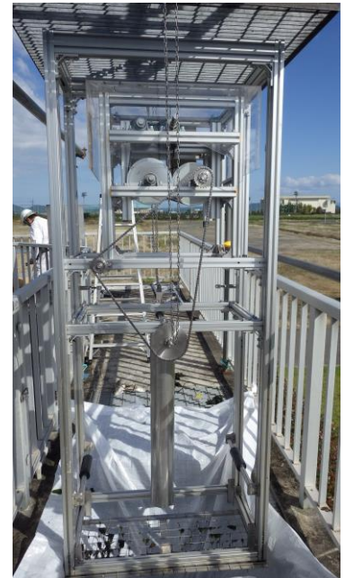
浄化センターに設置した Hydro-VENUS 実証機
