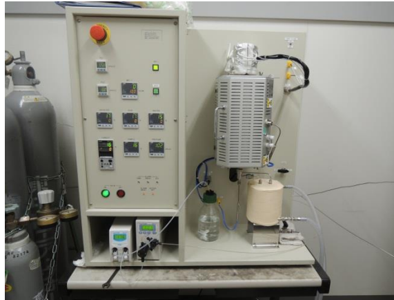
バイオガス改質装置
