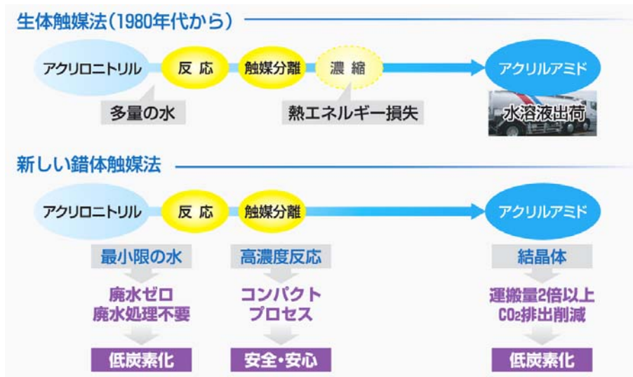
図 2. 生体触媒法と新しい化学触媒法(錯体触媒法)の比較
